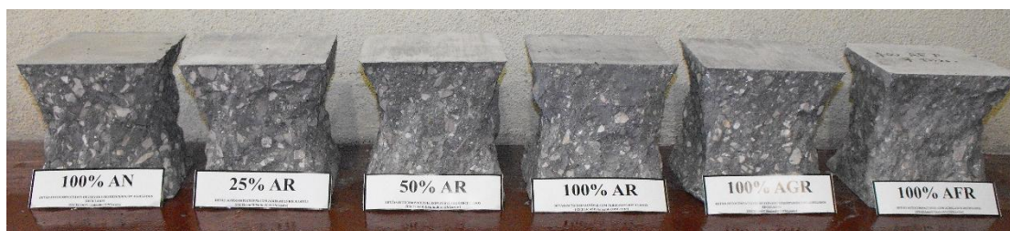
Figura 12 - Rotura apresentada pelos diferentes betões aos 7 dias de idade
