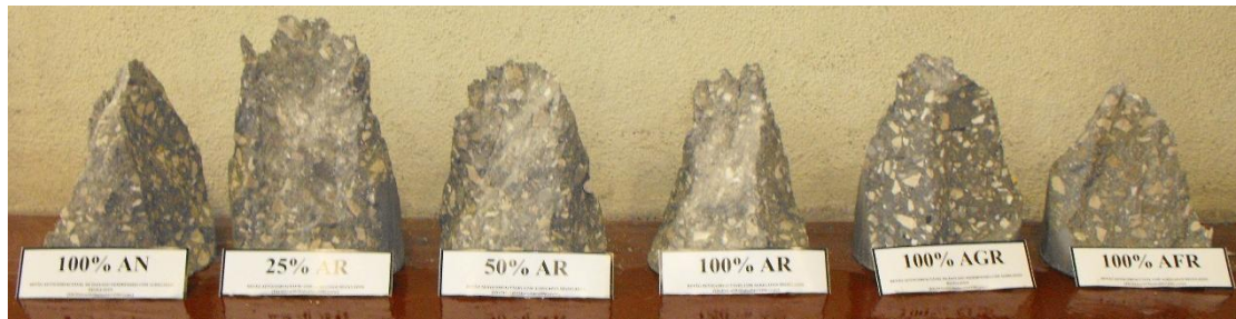
Figura 17 - Rotura apresentada pelos diferentes betões aos 28 dias de idade
