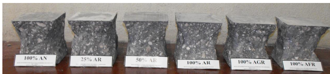
Figura 13 - Rotura apresentada pelos diferentes betões aos 28 dias de idade
