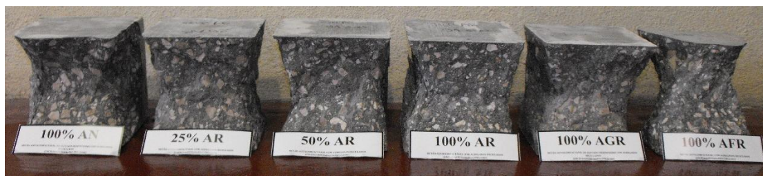
Figura 14 - Rotura apresentada pelos diferentes betões aos 91 dias de idade
