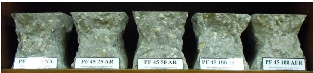
Figura 21 - Rotura apresentada pelos betões PF 45 aos 91 dias de idade
