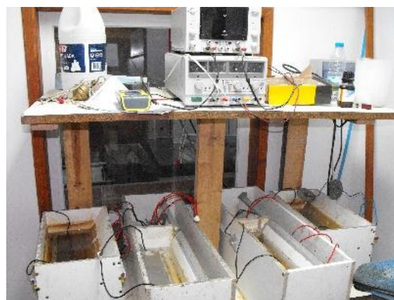
Figura 4.30 - Fonte de alimentação (em cima) e reservatórios de plástico (em baixo)
