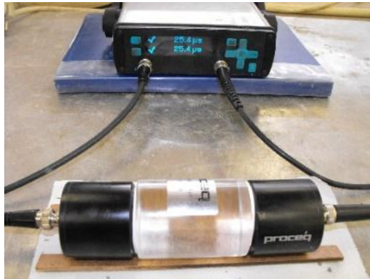
Figura 4.14 - Equipamento de ultra-sons (calibração do equipamento)
