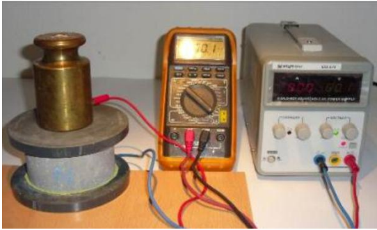
Figura 4.27 - Da esquerda para a direita: peso de 2 kg, placas de cobre, amperímetro e fonte de alimentação (Silva, 2013)
