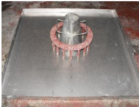
Figura 4.12 - Anel J de 16 varões, cone de Abrams e chapa metálica
