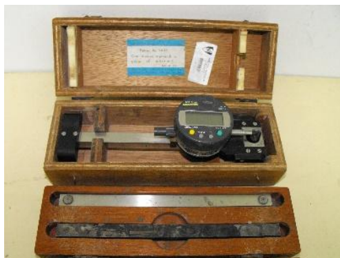
Figura 4.22 - Aparelho de medição de extensões, barra calibradora e barra padrão
