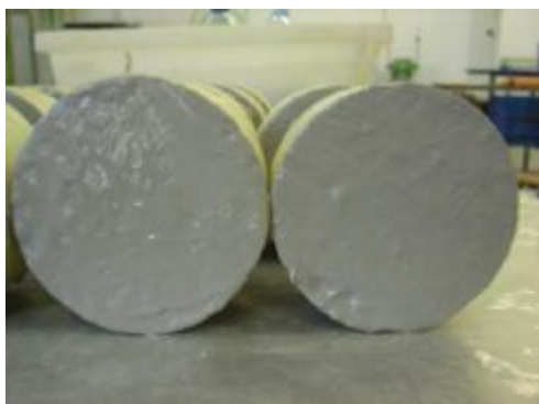
Figura 24. Superfícies pintadas com tinta epóxida.
