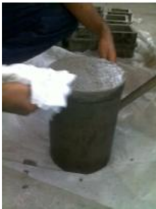
Figura 4. Remoção do excesso de betão.
