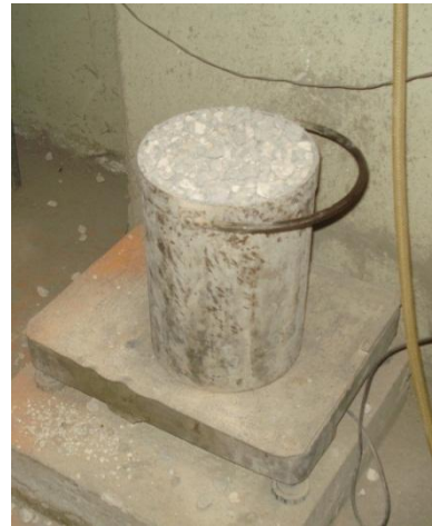
Figura 11. Pesagem do recipiente preenchido com agregado.
