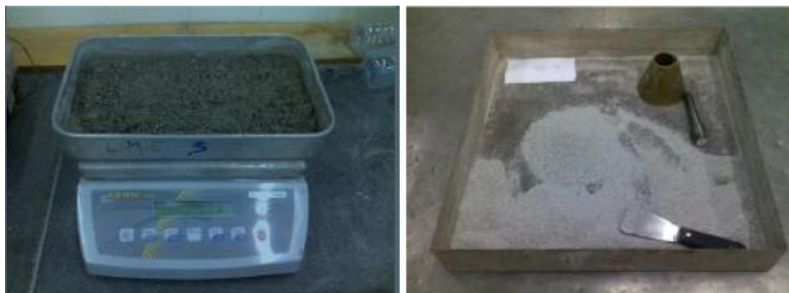
Figura 7. Pesagem e avaliação do estado saturado com superfície seca.
