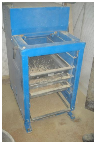
Figura 6. Máquina de peneiração com peneiros da série 933-2.
