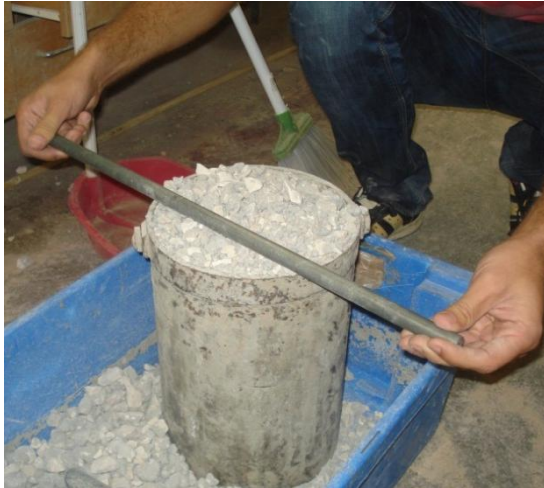
Figura 10. Remoção do material excedente.
