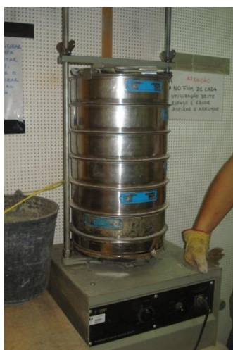
Figura 12. Máquina de peneirar e peneiros ASTM.
