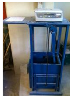
Figura 9. Ensaio da evolução da absorção de água dos AR a decorrer.
