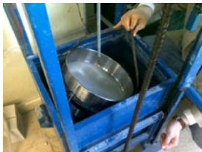
Figura 8. Submersão do conjunto (amostra, peneiros e suporte).
