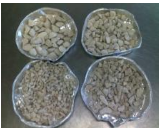
Figura 14. Agregados separados segundo a NP EN 933-2.
